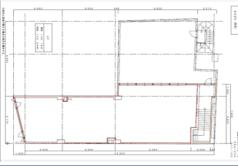
造 鉄筋コンクリート造陸屋根 地下2階付3階建
