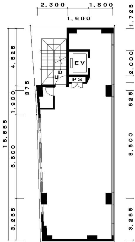
**構造** 鉄筋コンクリート造陸屋根
